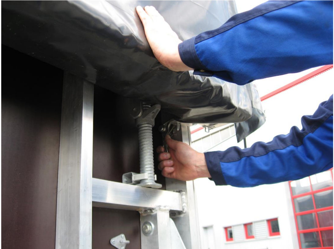
Bild 3 Winkelhebelverschlüsse des Daches öffnen
